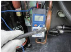
⑥冷媒配管温度測定
